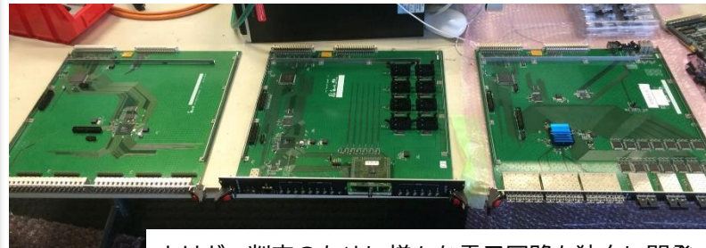
トリガー判定のために様々な電子回路も独自に開発
