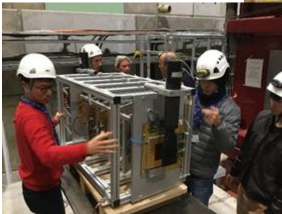
CERN (スイス) SPS ビームラインを用いた検出器のビームテスト
